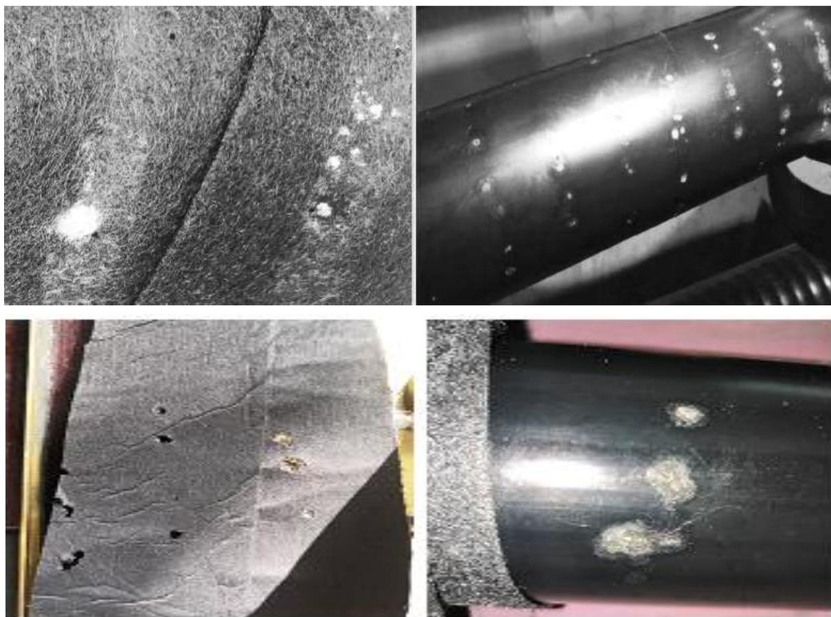
图 1 阻水型半导电缓冲带阻水粉析出和烧蚀
